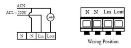
Fig. 4 BRT-406 wiring diagram
