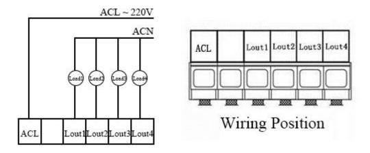
Fig. 3 BRT-115 Wiring Diagram
