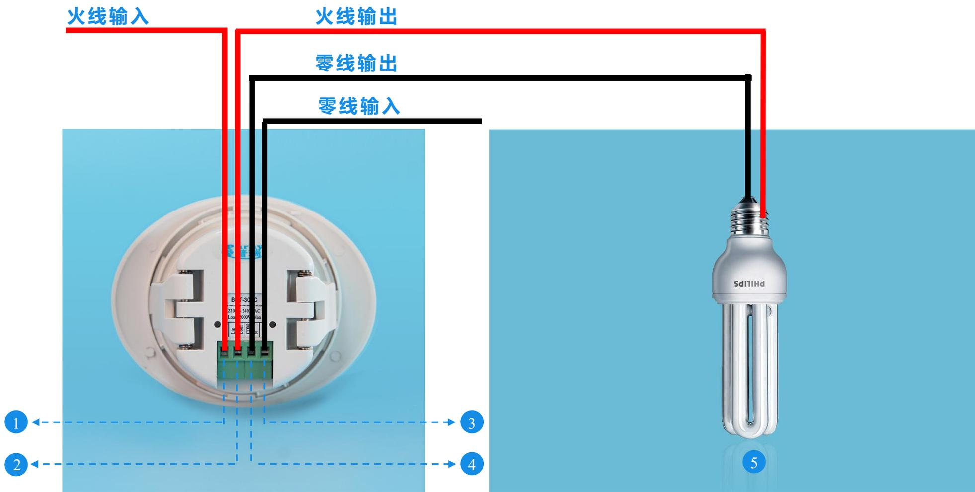
标注：① Lin: 火线输入接口 ② Lout: 火线输出接口 ③ COM: 零线输出接口 ④ N: 零线输入接口 ⑤ 负载 (灯具)
