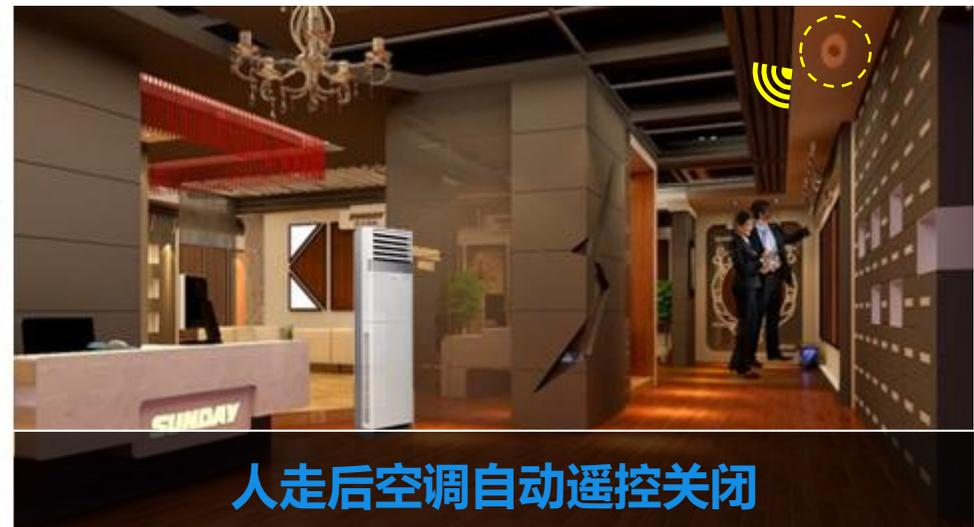
当 K380 和 s100 无线门控传感器相连接，即可根据人和门的关联自动控制空调的开关。人在室内时，空调保持开启。K380 感应到室内无人后，门若开启，空调 1 分钟后自动遥控关闭；门若仍处于关闭状态，空调可运行用户预先设定的时间后（1，2，5，10，15，20，25，30 分钟，用户可自行选择），自行遥控关闭。
