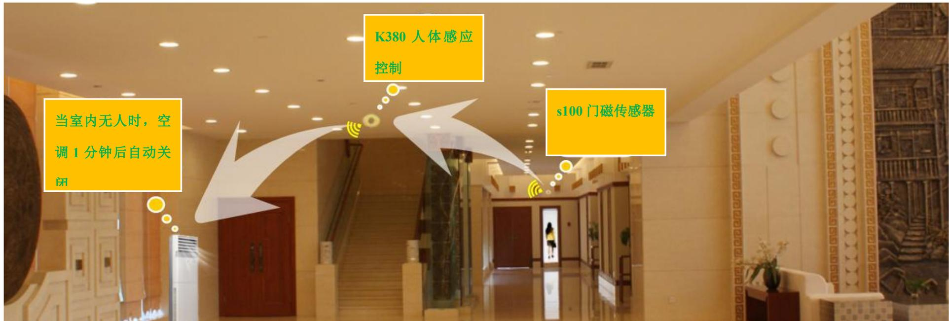
当室内无人并且大门处于开启状态时，门控传感器即向 K380 发送信息，K380 延时 1 分钟后自动遥控关闭空调
