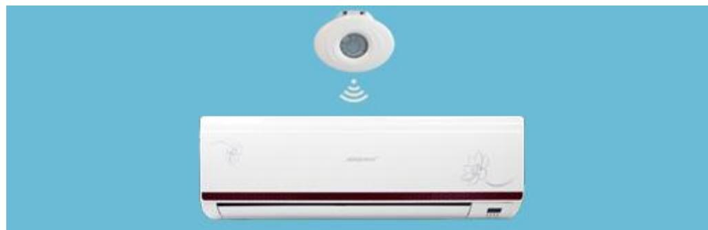
此款产品只需零火线接入，而无需与负载做任何连接。通过预先学习遥控器的红外码，自动遥控相应负载，因此也无需考虑负载功率。
